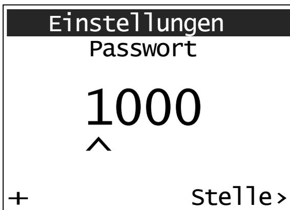
Im Menüpunkt Einstellungen kann der Anwender einige Anpassungen des Gerätes vornehmen. Dazu muss erst einmal das Passwort eingegeben werden. Mit F1(+) wird die angezeigte Stelle inkrementiert (0-9) und mit F2 (Stelle>) kann die nächste Stelle ausgewählt werden. Durch die Taste „Menu“ wird das Passwort bestätigt. Die Voreinstellung des Passwortes ist <1000> und kann mit einer speziellen Software geändert werden.
