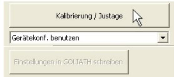
In diesem Beispiel wird „**Gerätekonf. benutzen**“ ausgewählt. Mit dieser Einzelgaseinstellung kann ein einzelner Sensor geprüft werden.
